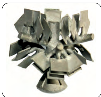
Модель из сплава (никель-хром) Пластины 0.3-0.5 мм демонстрирует возможность минимальной толщины отливки.
